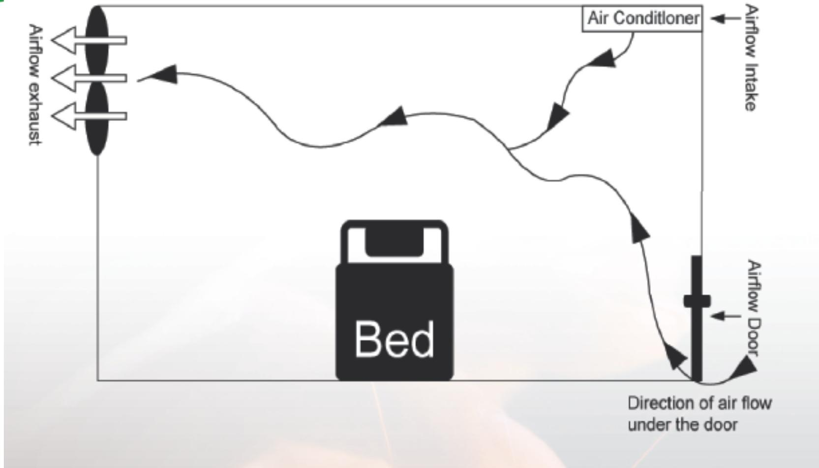
負壓房間氣流示意圖，空氣從屋外進入透過病人的床，廢氣被排到很遠處門下方的空氣流動方向：相對於走廊(前室)的負壓
